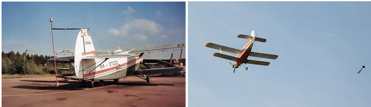
Рис. 1. Аэромагнитная вертикальная градиентометрическая система, смонтированная на хвостовой балке самолета Ан-2
