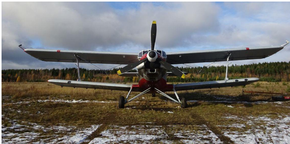
Рис. 3. Аэромагнитная горизонтальная градиентометрическая система, смонтированная на самолете Ан-3.
