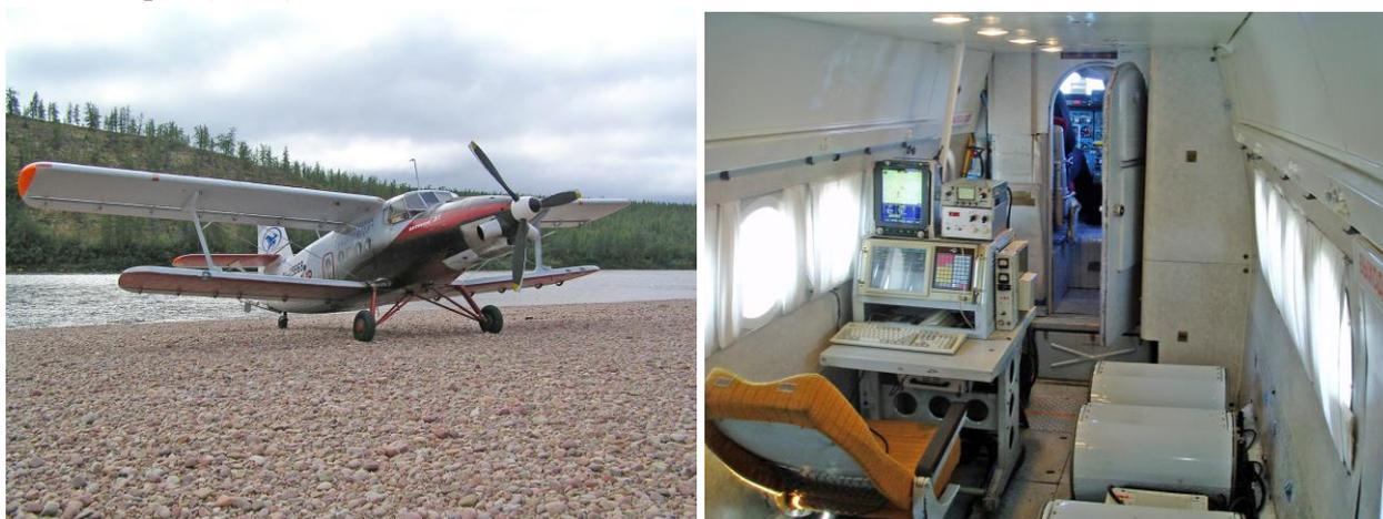
Рис.1. Самолет Ан-3т с установленной внутри фюзеляжа аэрогеофизической станцией КАС
