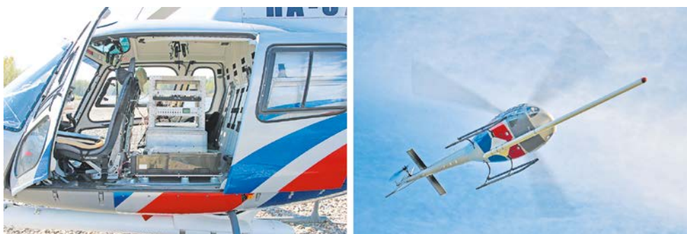
Рис. 2. Размещение аэрогеофизического комплекса на вертолете Eurocopter AS350-B3
