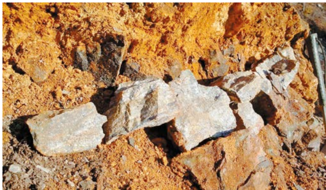
Рис. 9. Рудопоявление «Голубое» (т.н. NF-2019-36): рудная зона (мощностью 0,6 м) с окисленными вторичными (малахит, азурит, гидроокислы железа) и первичными (пирит, халькопирит, галенит, сфалерит) рудами прожилкового типа
