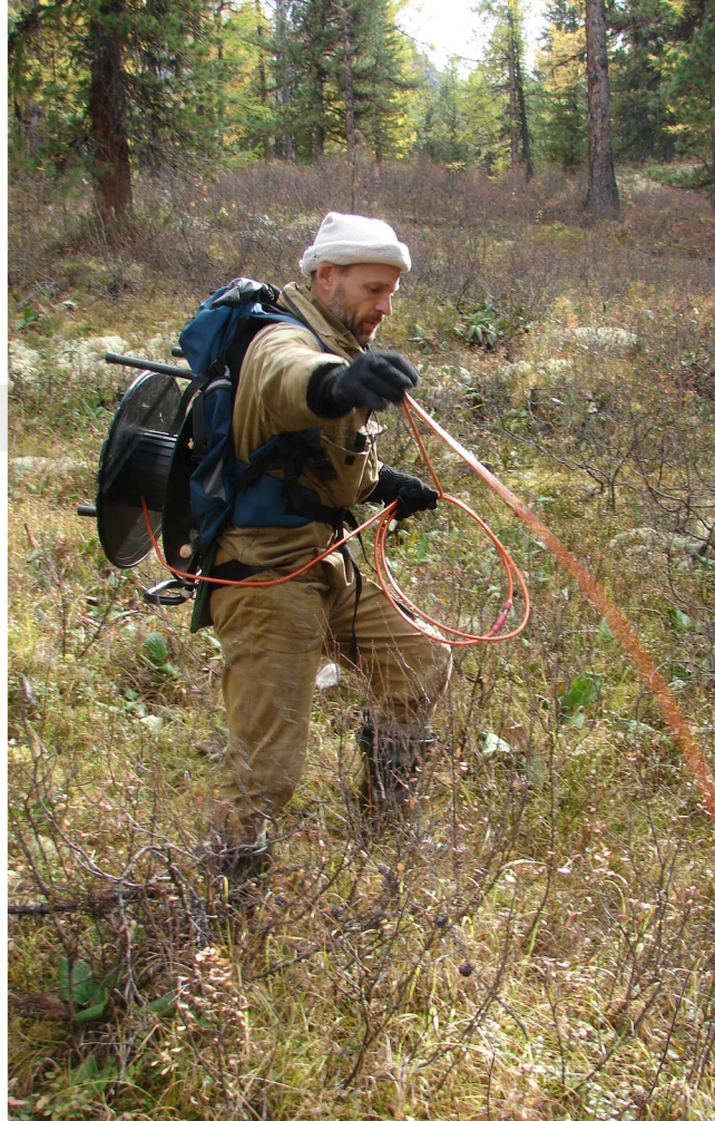
Рис.5 Процесс смотки электроразведочной косы (Белов Д.А)
